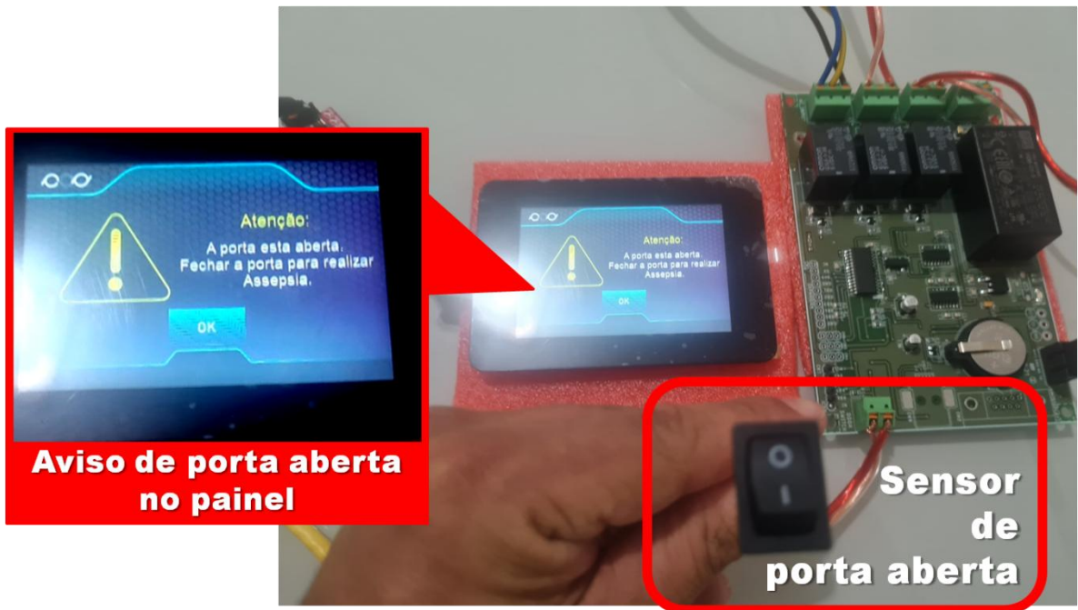
FIGURA 31 – Simulação de acesso indevido/porta aberta durante a Asepsia, utilizando-se chave/interruptor como exemplo de dispositivo de aviso (posição “0”).
