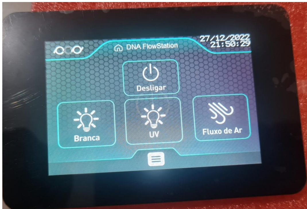
Figura 16 – Interface Principal mostrando botões virtuais e as respectivas funções.
