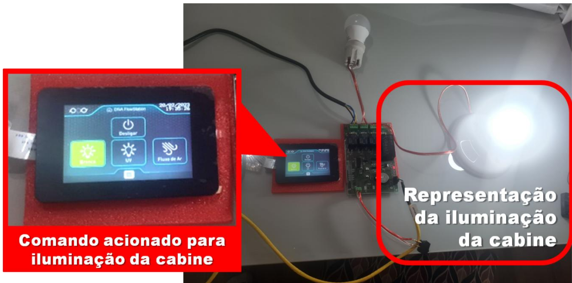
FIGURA 33 – Simulação do acionamento luz branca para iluminação interna da cabine.
