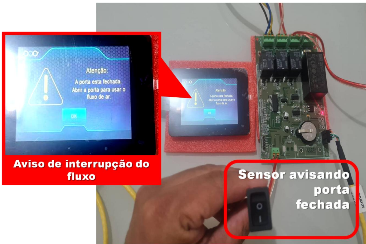
FIGURA 32 – Simulação de fluxo de ar interrompido devido a porta fechada, utilizando-se chave/interruptor como exemplo de dispositivo de aviso (posição “1”).
