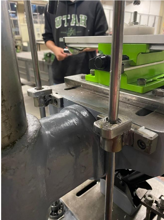
Figura 14 - Mancais com rolamentos fixados a sela
