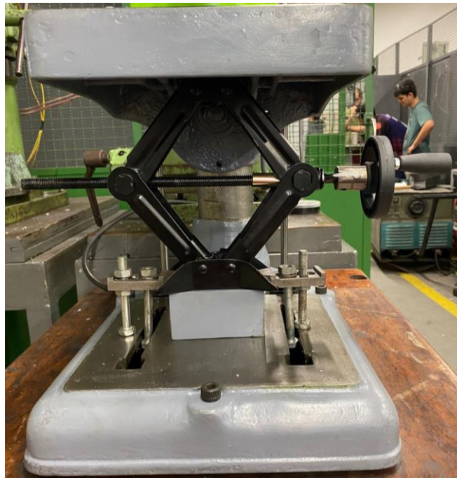
Figura 3 - Macaco mecânico fixado junto a estrutura da máquina.
