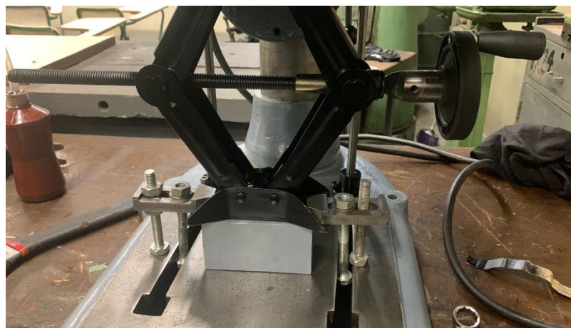
Figura 13 - Macaco com manipulo fixados a base
