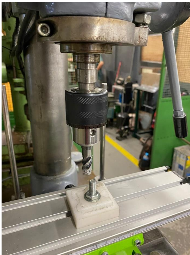
Figura 15 - Cone morse, mandril e ferramenta fixados
