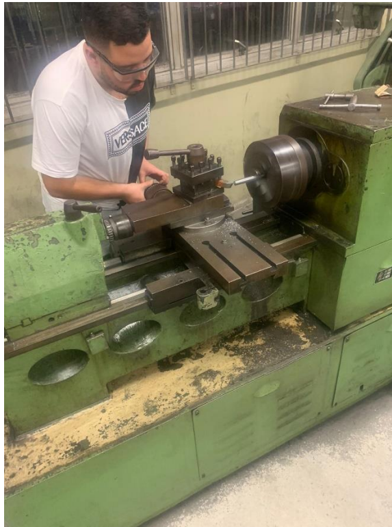
Figura 7 - Ajustagem do cone Morse do mandril
