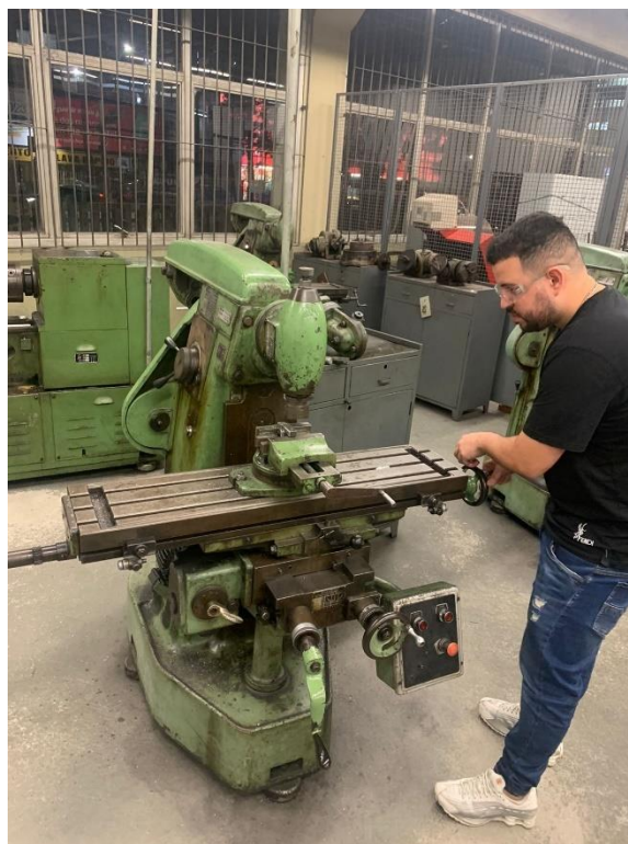
Figura 8 - Ajustagem dos mancais das guias
