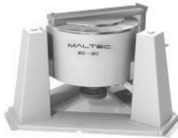
Figura 53 - Centrifuga tripé de 30 kg
