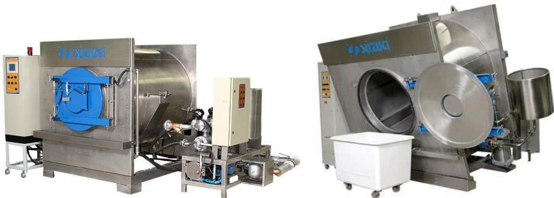
Figura 50- Lavadora para Stone Wash e Tingimento - 100 Kg
