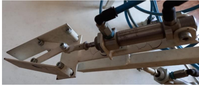
Figura 38: Garra de dois dedos com função de pinça, atuada por cilindro pneumático.
