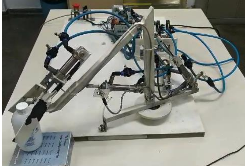
Figura 60: Antebraço abaixado, posicionando a garra para retirada da peça.
