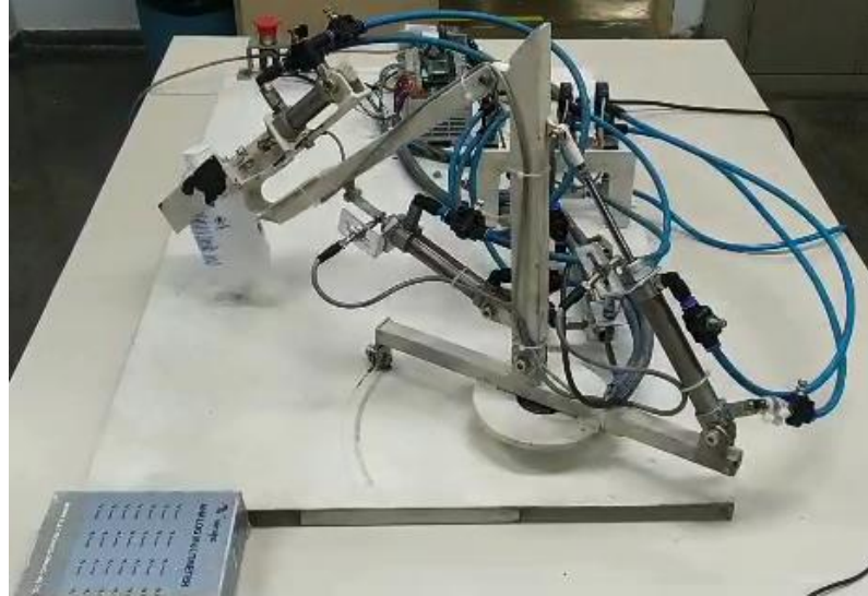
Figura 66: Antebraço abaixado para entrega da peça.
