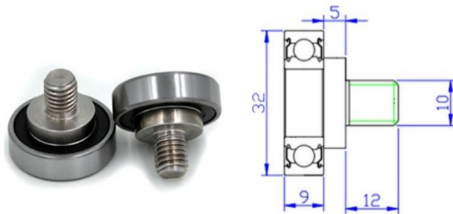
Figura 24: Mancal redondo com rolamento de aço 6002zz com 303 parafuso 10x12 material de aço inoxidável (escala em milímetros).
