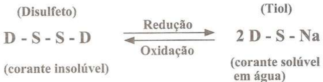
Figura 9 – Redução e oxidação do Corante Sulfuroso (formação de um tiol)
