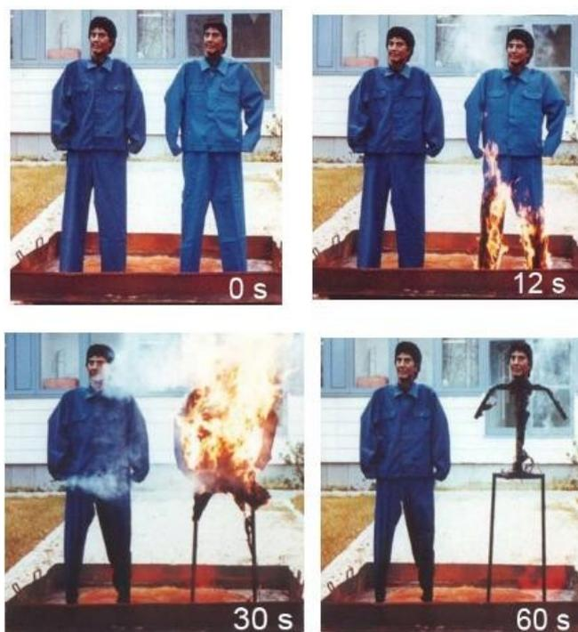
Figura 14- Teste Desempenho Proteção Térmica
