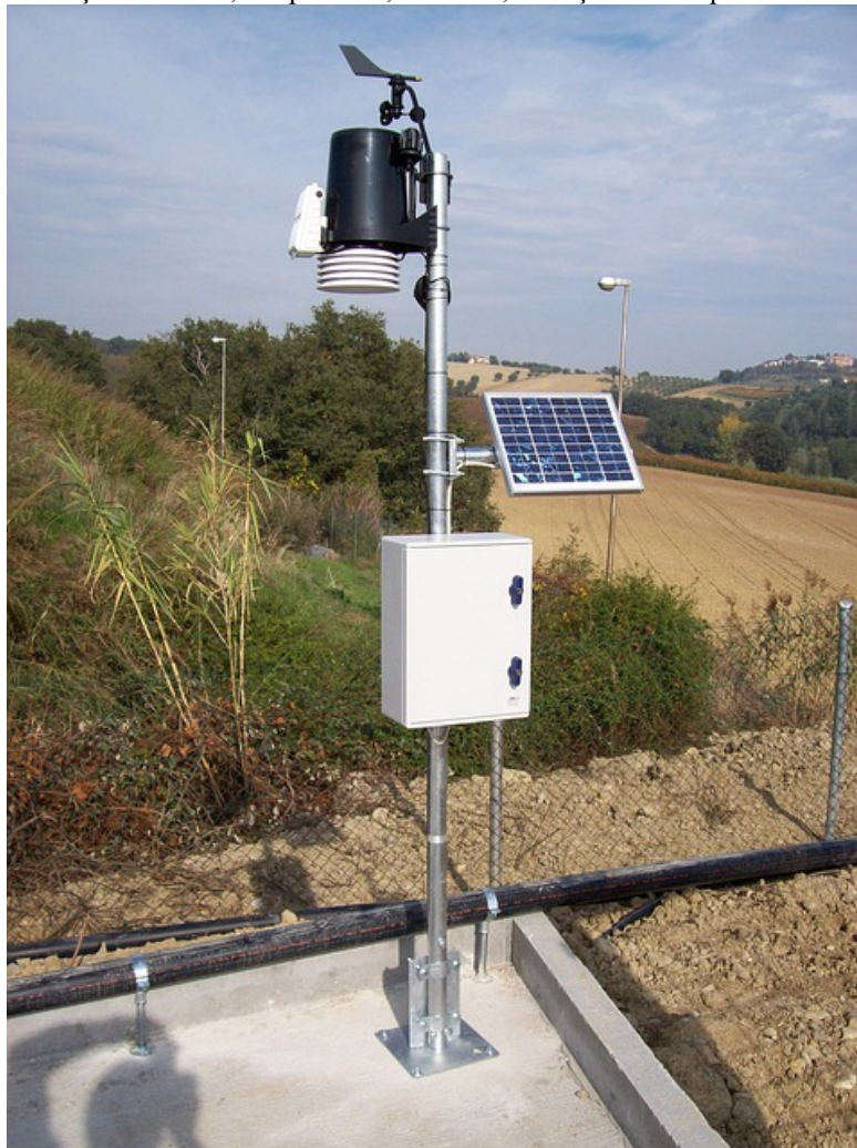
Figura 2 – Imagem de uma estação meteorológica automática. Uma estação deste modelo é capaz de medir chuva, intensidade e direção do vento, temperatura, umidade, radiação solar e pressão atmosférica.
