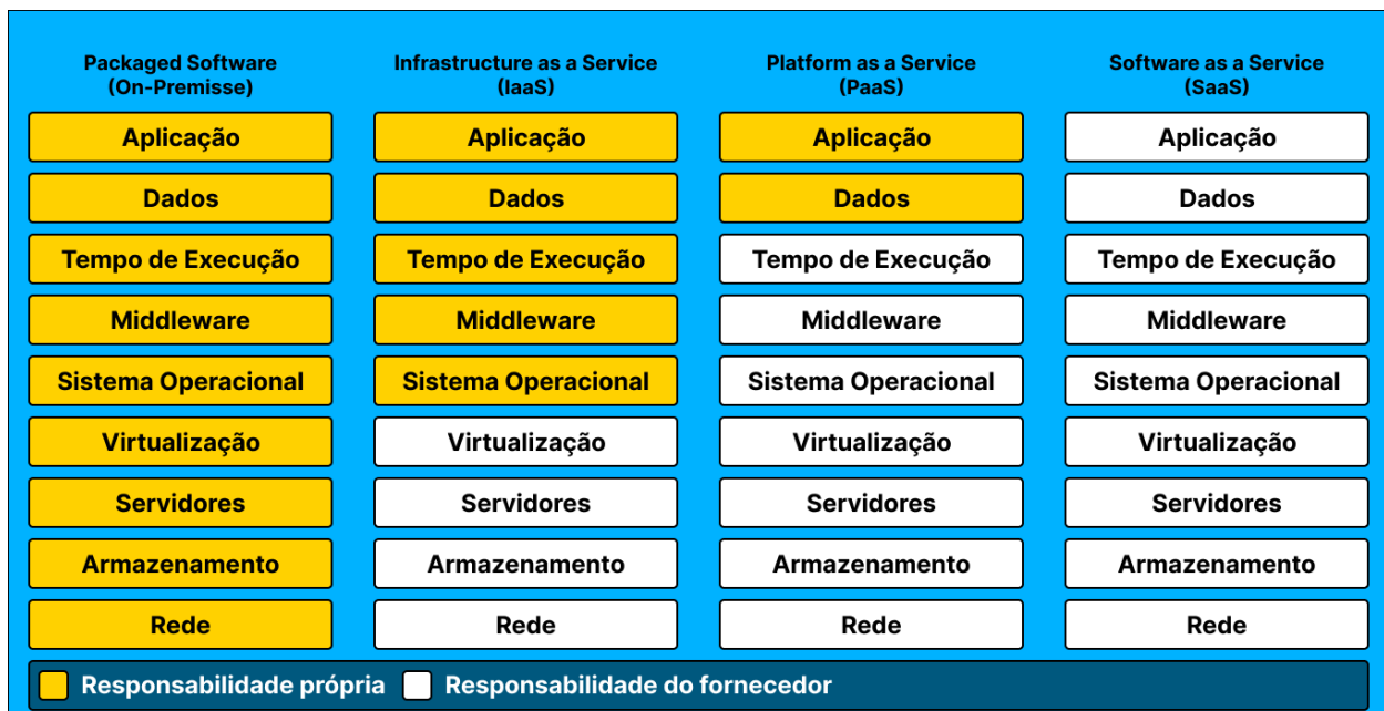
Figura 10: Conforme aumentamos o nível do serviço em cloud computing reduzimos a responsabilidade da empresa contratante do serviço e aumentamos a responsabilidade dos fornecedores da solução em cloud.
