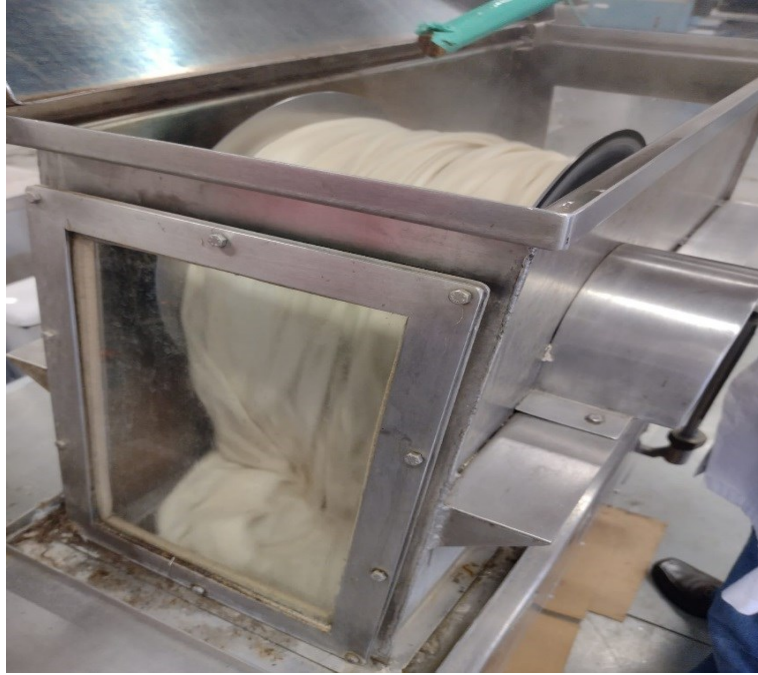
Figura 2 - Início do processo de Desengomagem, purga e alvejamento
