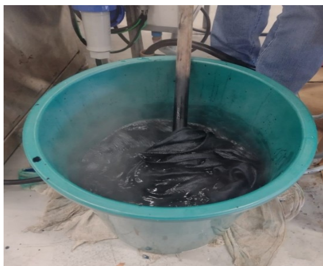
Figura 11 - Tingimento manual com corante reativo
