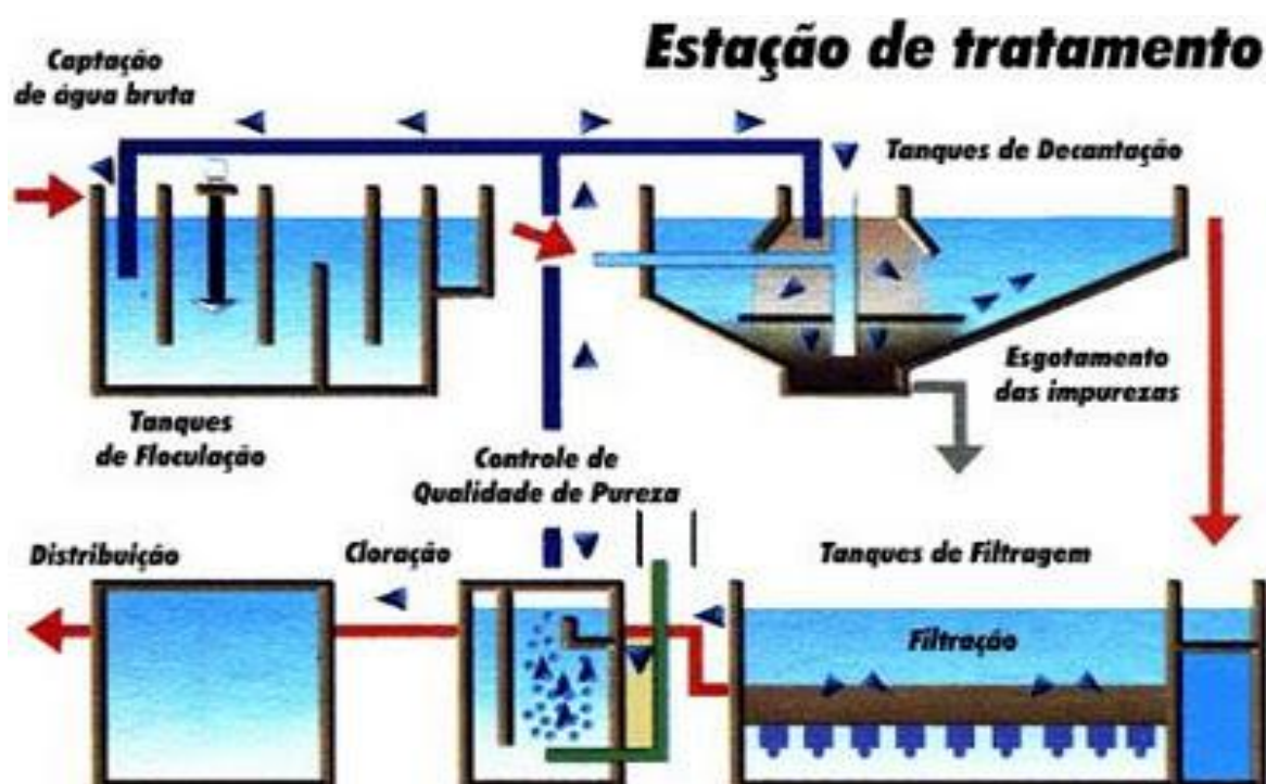
Figura 8: ETE (estação de tratamento) básica
