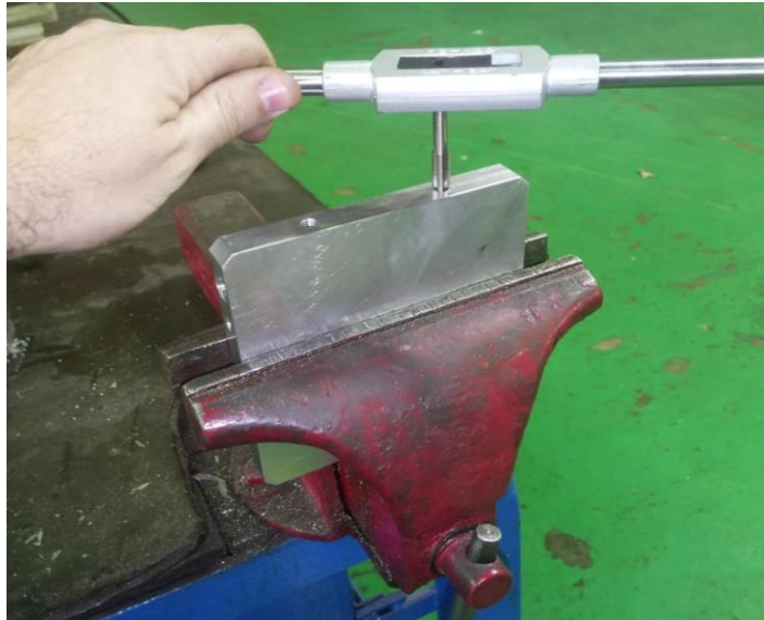
Figura 15 – Processo de rosqueamento com macho m8. Fonte: Autores, (2023).
