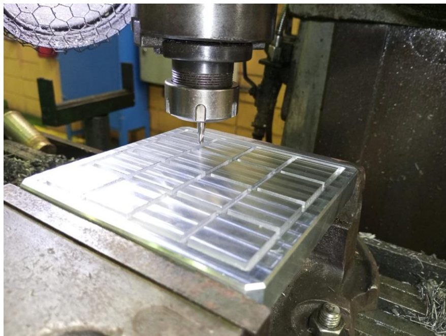
Figura 11 – Realizando o Fresamento da chapa para as ranhuras. Fonte: Autores, (2023).
