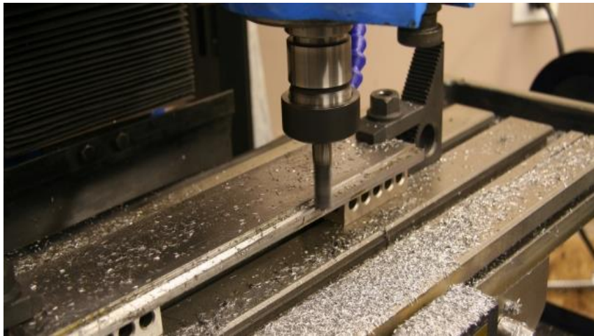
Figura 24 – Fixação direto na mesa da fresadora. Fonte: Autores, (2023).
