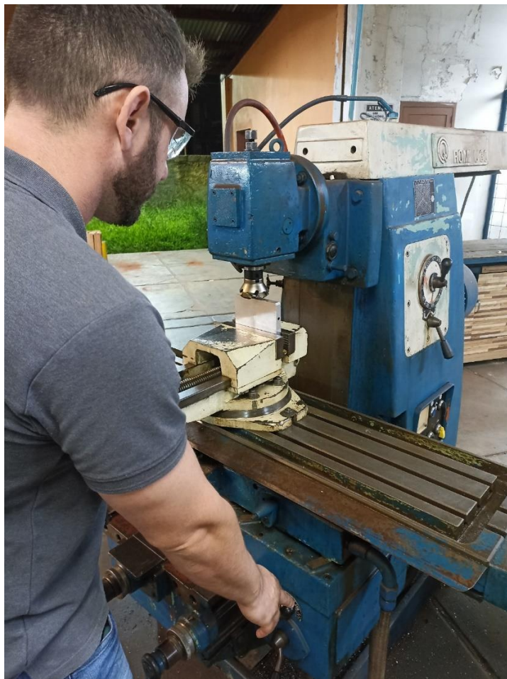
Figura 9 – Fresamento lateral da placa de alumínio. Fonte: Autores, (2023).
