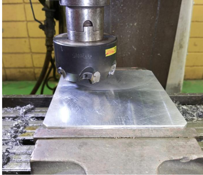
Figura 10 – Fresamento horizontal da placa. Fonte: Autores, (2023).
