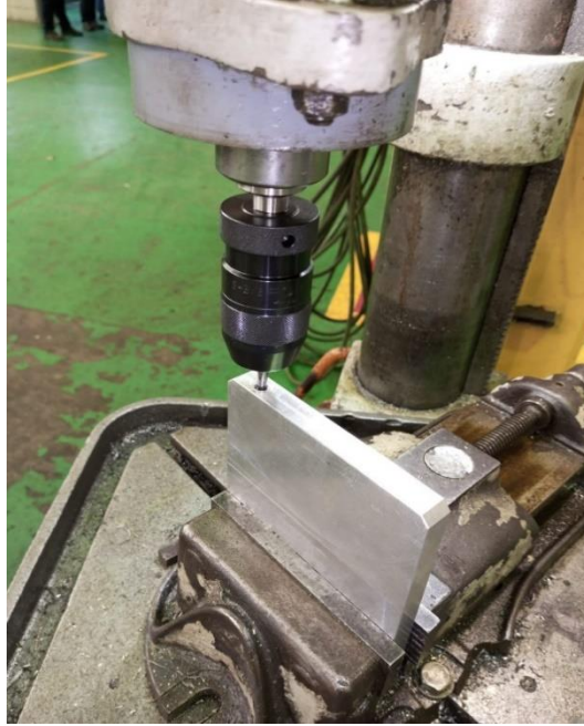
Figura 12 – Furação lateral. Fonte: Autores, (2023).
