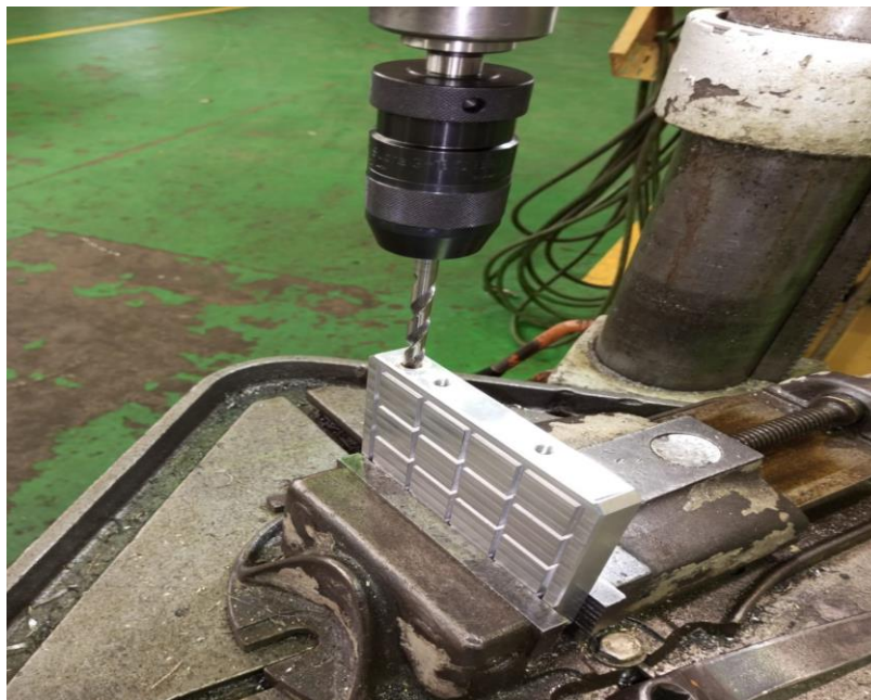
Figura 10 – Reabertura do furo 6mm. Fonte: Autores, (2023).
