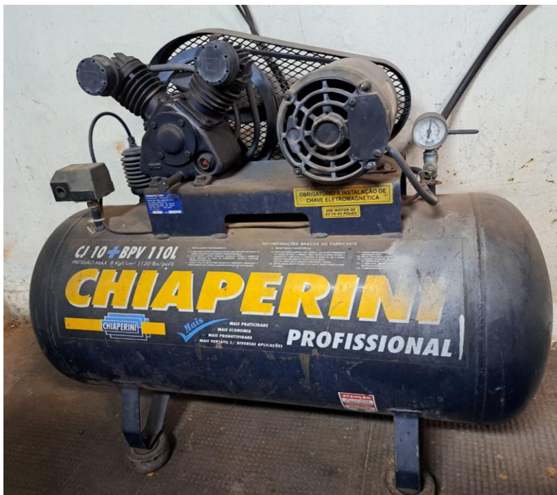
Figura 17 – Compressor de ar comprimido elétrico. Fonte: Autores, (2023).
