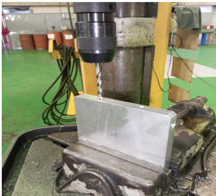
Figura 132 – Reabertura do furo 6,5mm. Fonte: Autores, (2023).
