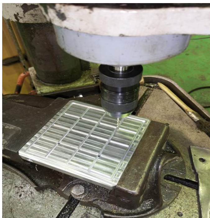
Figura 14 – Furação para aspiração de vácuo. Fonte: Autores, (2023).
