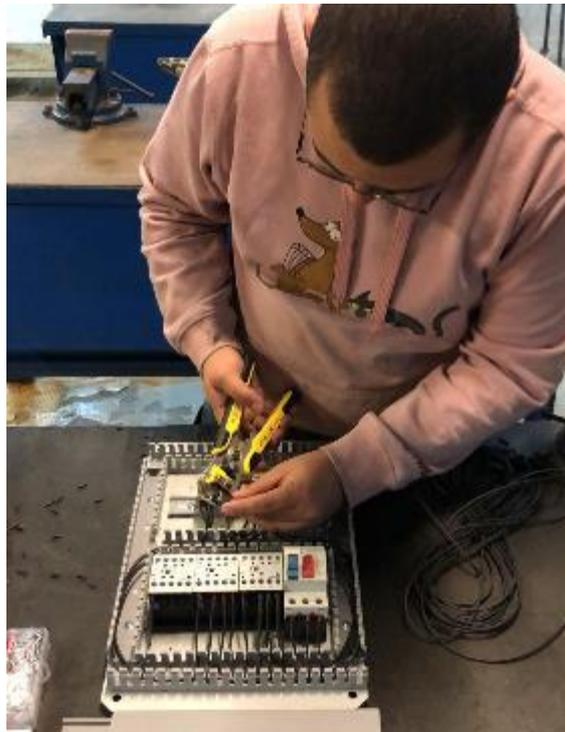
**Figura 32** – Aluno montando painel elétrico
