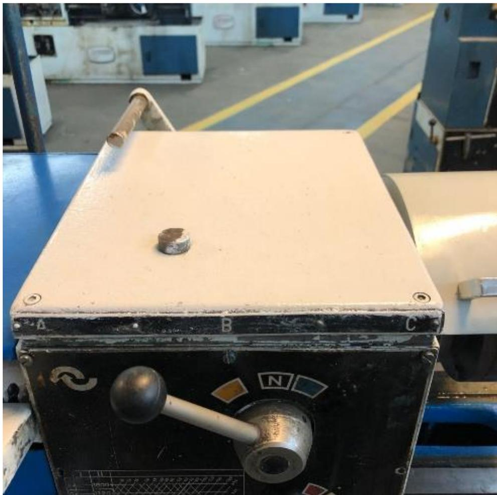
**Figura 25** – Tampa do cabeçote fixo
