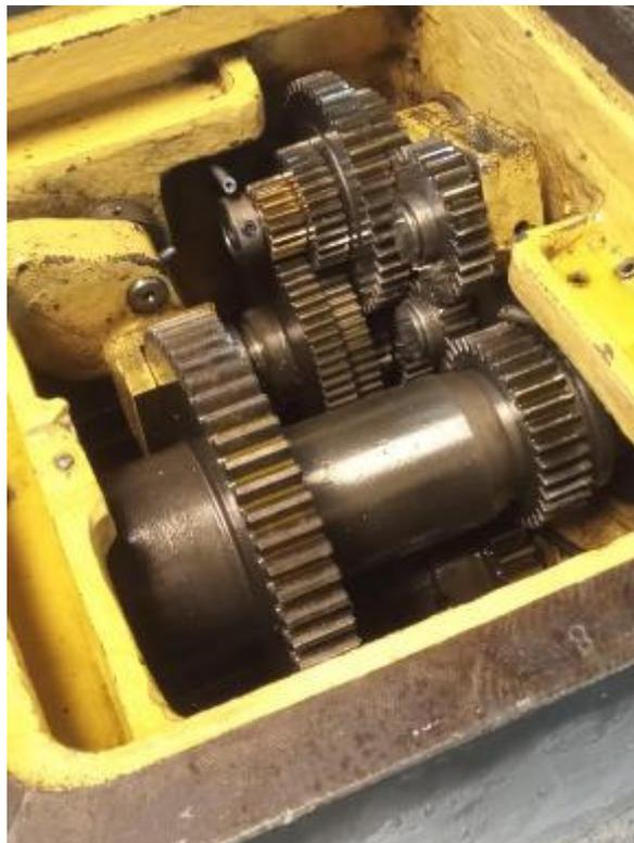
**Figura 16**– Engrenagens da caixa de velocidade
