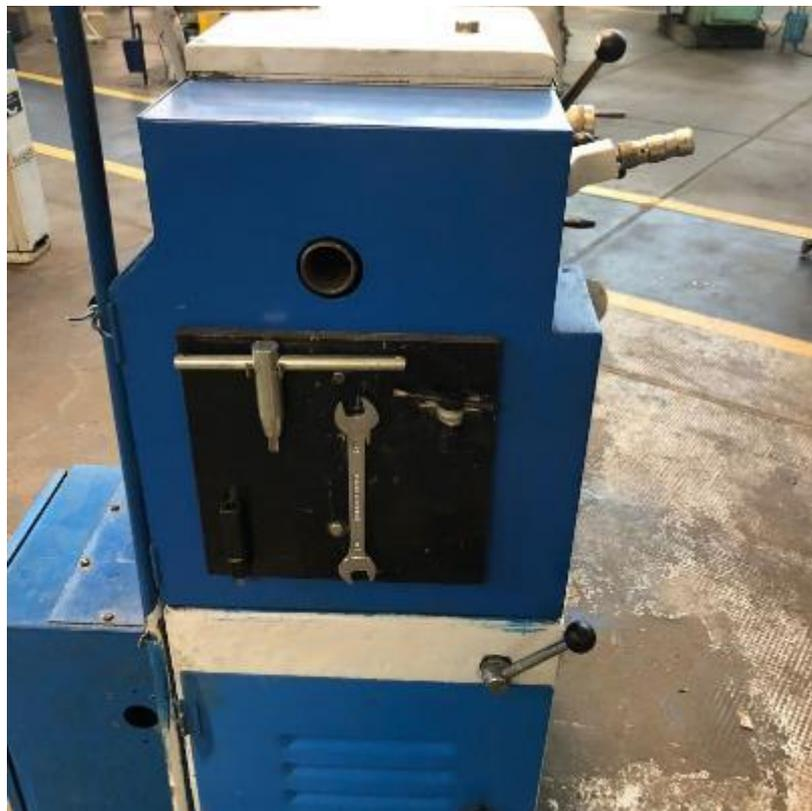
**Figura 29** – Proteção do recambio com o suporte de ferramentas
