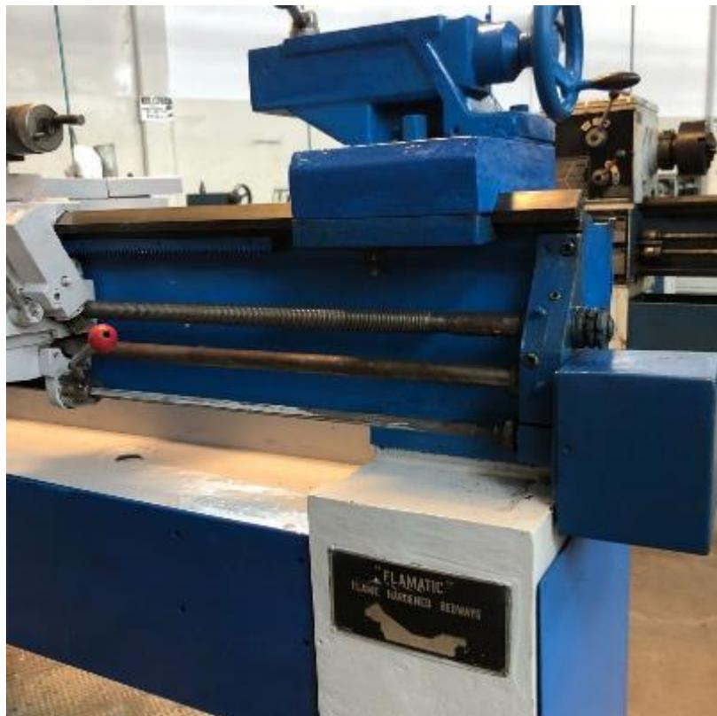
**Figura 27** – Fusos de movimentação automática
