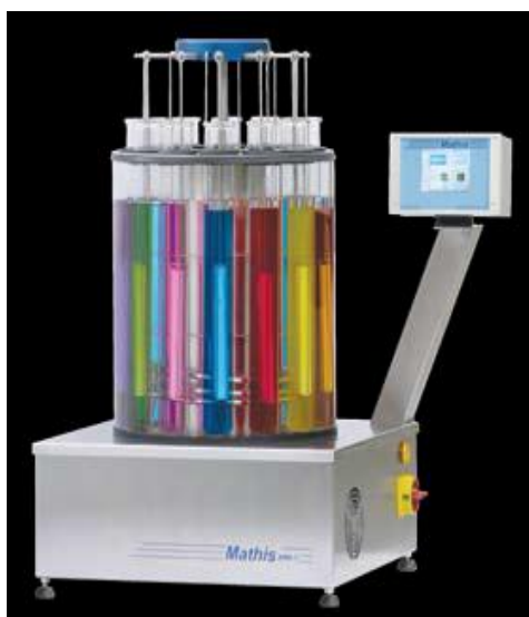
Figura 29: Máquina de tingimento em baixa temperatura 95°C. Fonte: Mathis Ltda.
