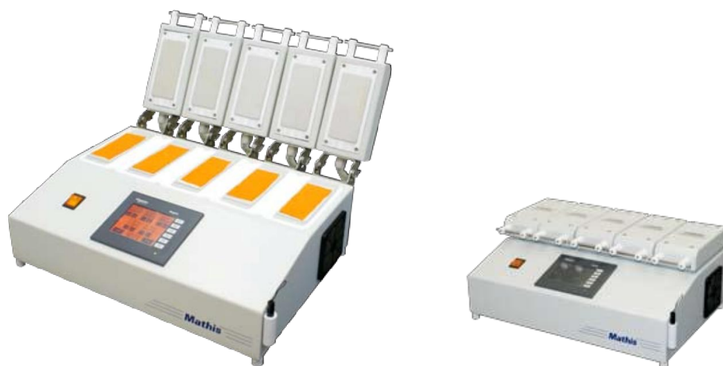
Figura 23: Máquina de teste de sublimação de laboratório. Fonte: Mathis Ltda.
