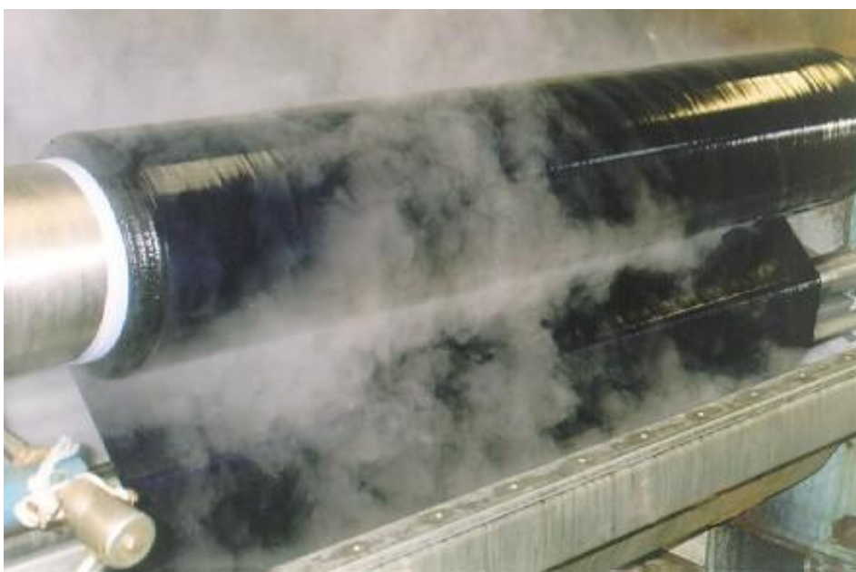
Figura 4: Jigger em funcionamento. Fonte: CEFET/SC.
