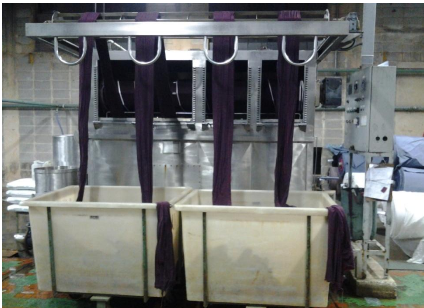
Figura 9: Funcionamento do Overflow.
