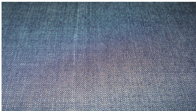
Figura 6 Defeito de tecelagem, urdume esticado.
