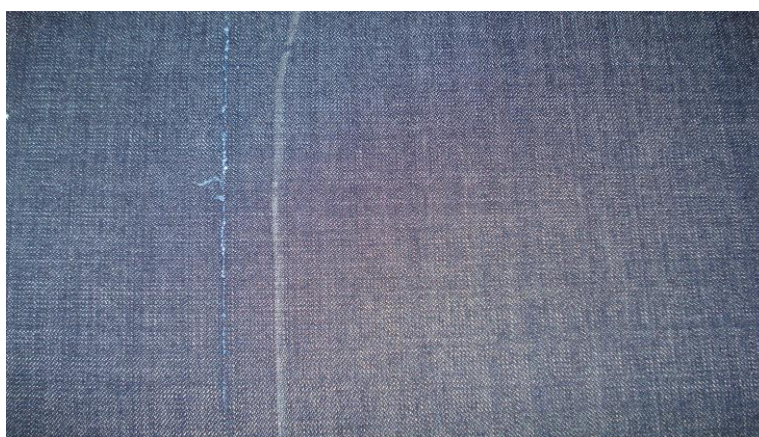
Figura 1 Defeito de tecelagem, urdume frouxo.
