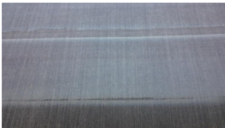
Figura 25 Defeito de beneficiamento, marcas de cilindro.
