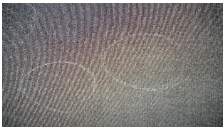
Figura 7 Defeito de tecelagem, ruptura de trama.
