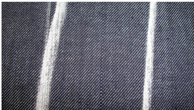
Figura 3 Defeito de tecelagem, urdume duplo.
