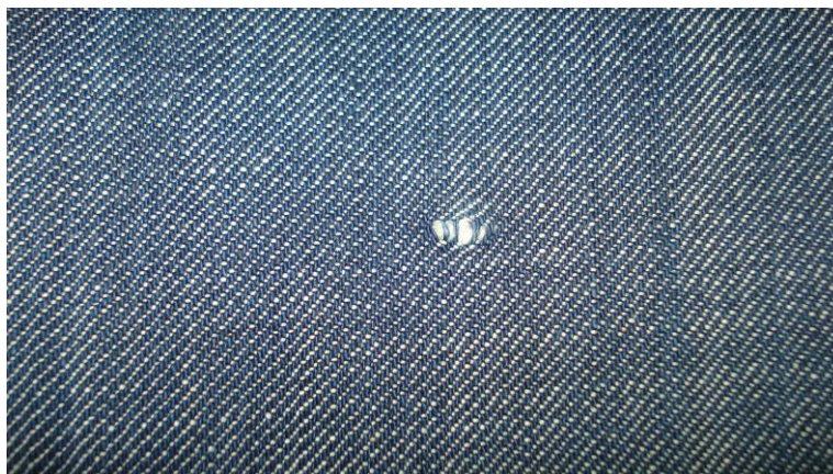
Figura 18 Defeito de tecelagem, apeloado.
