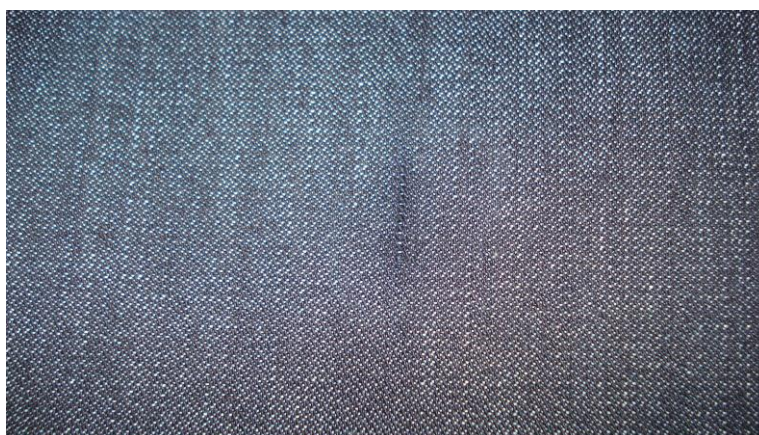
Figura 20 Defeito de fiação, fio grosso urdume.
