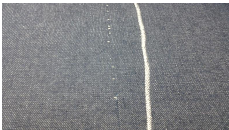
Figura 16 Defeito de tecelagem, canastra. Fonte: Ilustração da autora (2012) Americana/SP, Brasil.
