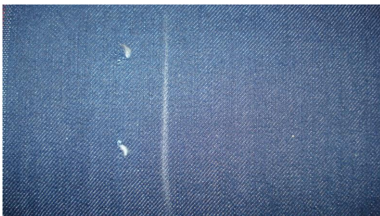
Figura 4 Defeito de tecelagem, nó de urdume.
