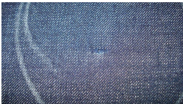
Figura 19 Defeito de tecelagem, correção mal feita.
