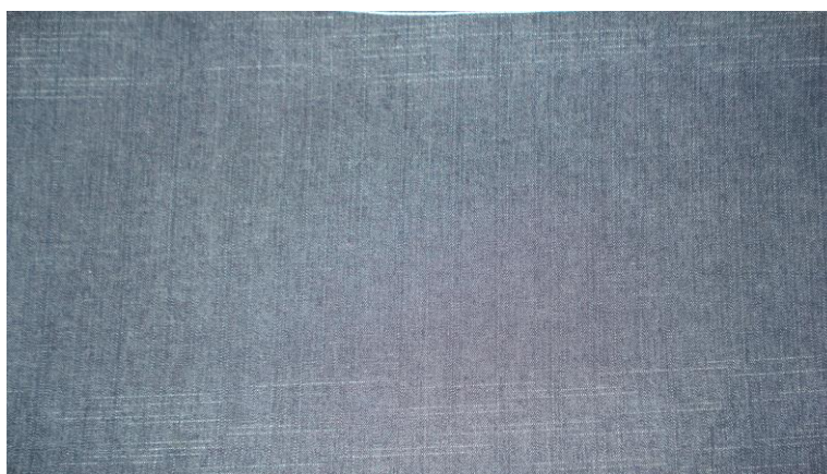
Figura 8 Defeito de tecelagem, trama misturada.
