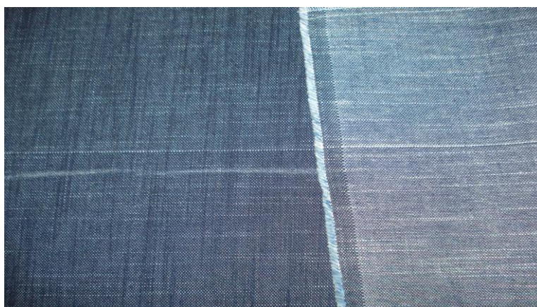
Figura 14 Defeito de tecelagem, trama dupla.
