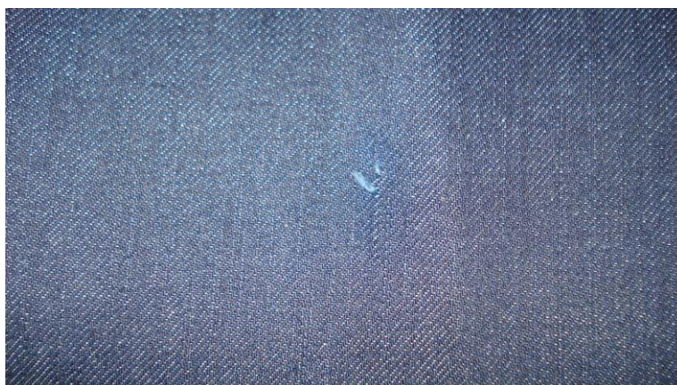
Figura 10 Defeito de tecelagem, ruptura de urdume.
