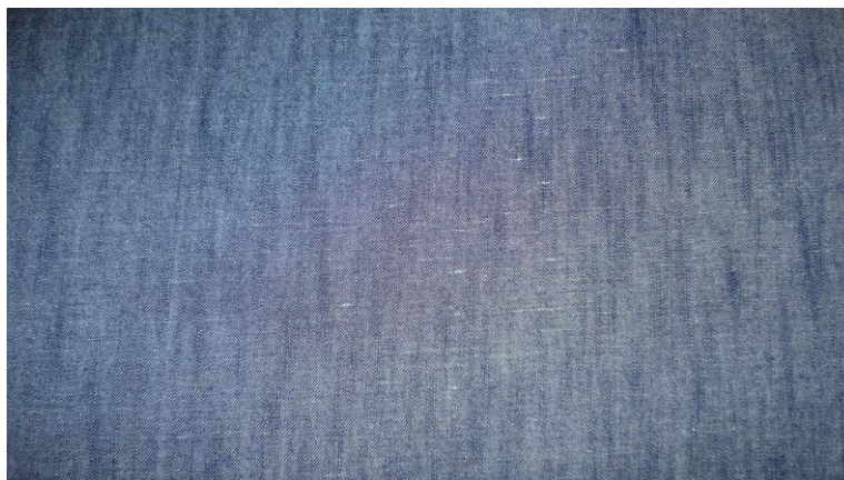
Figura 21 Defeito de fiação, fio irregular.
