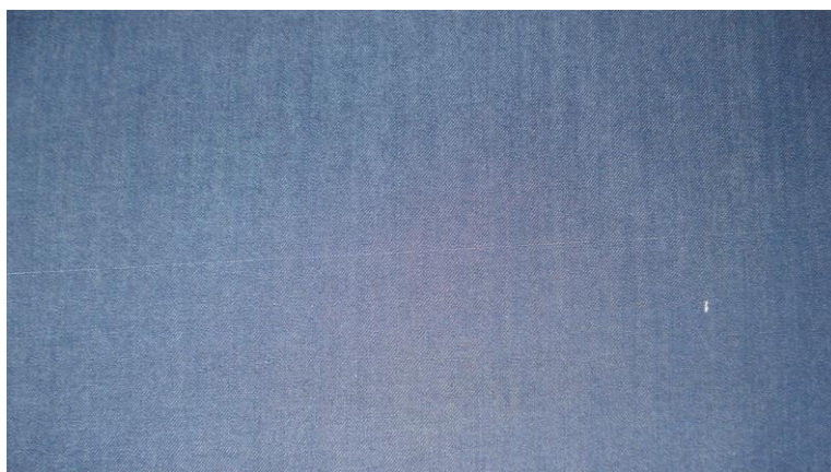
Figura 13 Defeito de tecelagem, trama frouxa.
