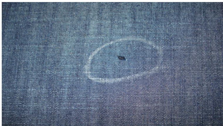
Figura 15 Defeito de tecelagem, bolinha de engomagem. Fonte: Ilustração da autora (2012) Americana/SP, Brasil.
