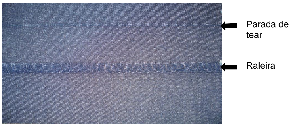
Figura 9 Defeito de tecelagem, marca de parada de tear e o defeito raleira.
