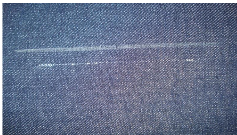
Figura 2 Defeito de tecelagem, estripada.
