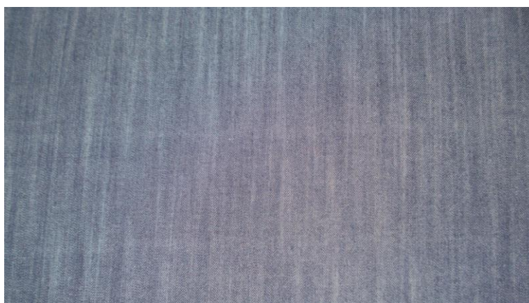
Figura 11 Defeito de tecelagem, variação de batidas.
