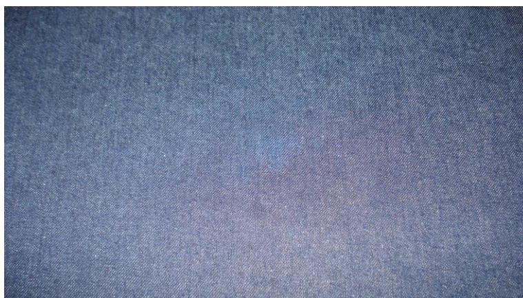
Figura 22 Defeito de beneficiamento, manchas de cor diferente.
