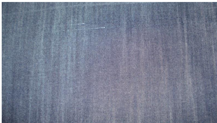
Figura 12 Defeito de tecelagem, trama curta.
