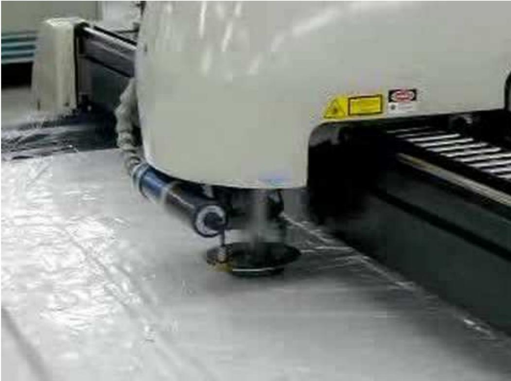
**Figura 13:** Máquina de corte por ar comprimido Gerber Cutter.
