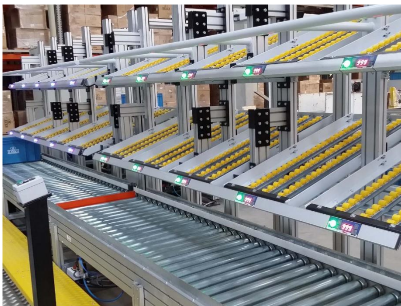
Figura 5 - Sistema de Picking. Fonte: Cassioli. Disponível em: https://www.cassioli.com.br/divisao-intralogistica/centros-de-distribuicao-e-sistemas-de-picking/pick-to-light/ . Acesso em: 04 de junho de 2023.
