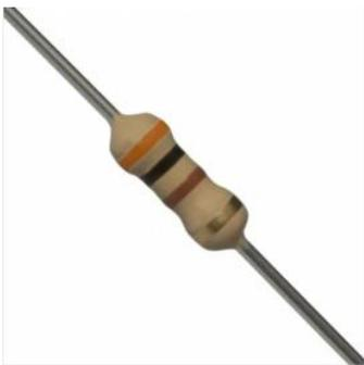
*Figura 12 Resistor 330ohms*
