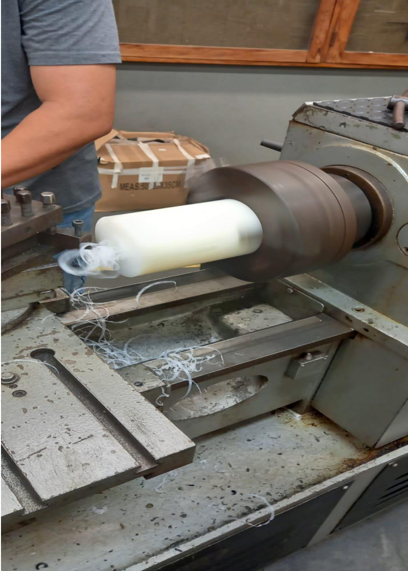
Figura 21: Processo de usinagem do copo de alimentação
