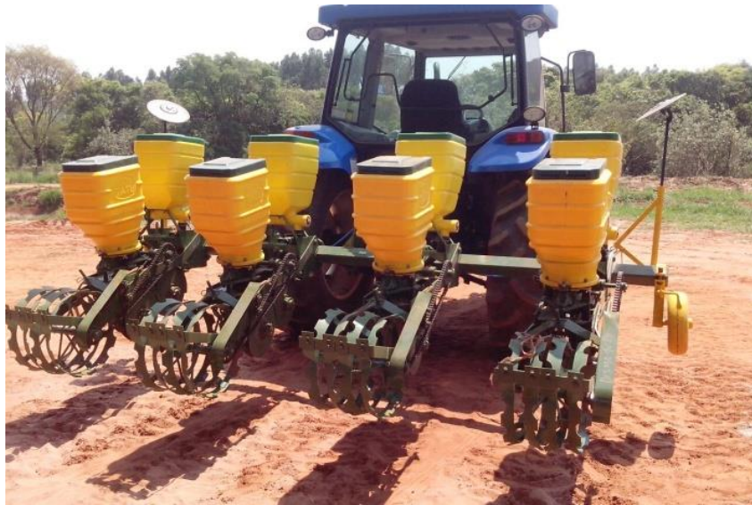
Figura 6: Semeadora adubadora de plantio convencional, linha dupla e acoplamento aos 3 pontos utilizada a cultura do amendoim. Fonte: Do autor.
