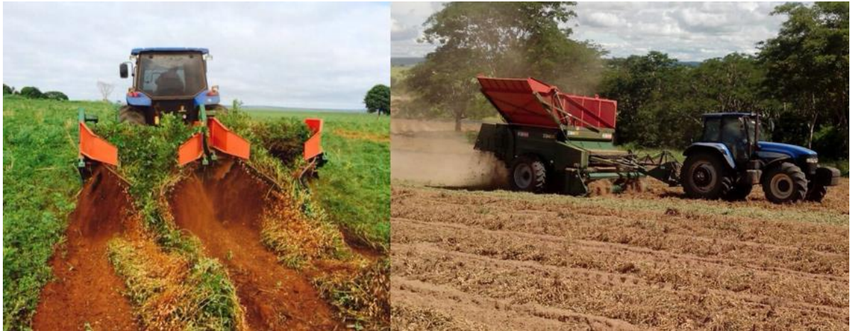
Figura 16: Máquinas utilizadas na colheita do amendoim – Arrancadora (a esquerda) e Recolhedora (a direita). Fonte: Do autor
