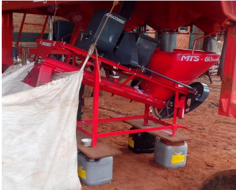
Figura 7: Máquina utilizada para realização de tratamento de sementes. Fonte: Do autor.
