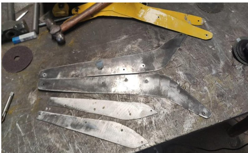
Figura 1: Recorte das chapas do braço da retroescavadeira
