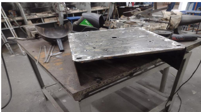
Figura 2: Base onde sustenta o braço da retroescavadeira
