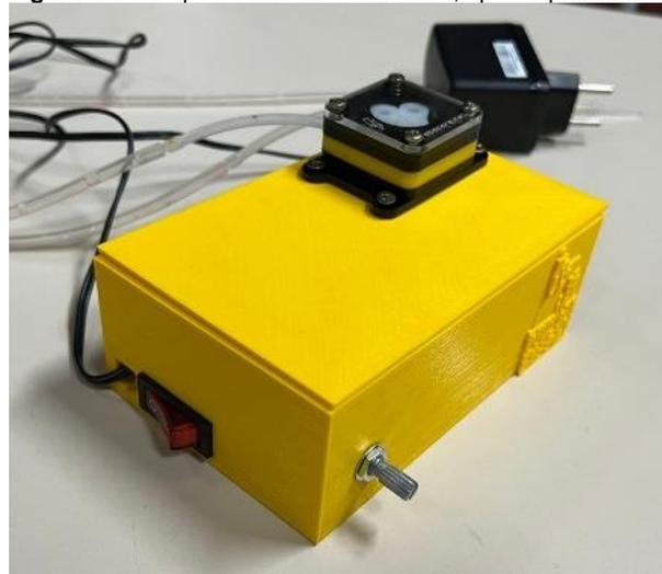
É possível observar a bomba peristáltica, a fonte, o interruptor e o potenciômetro, para o controle do agitador magnético.
