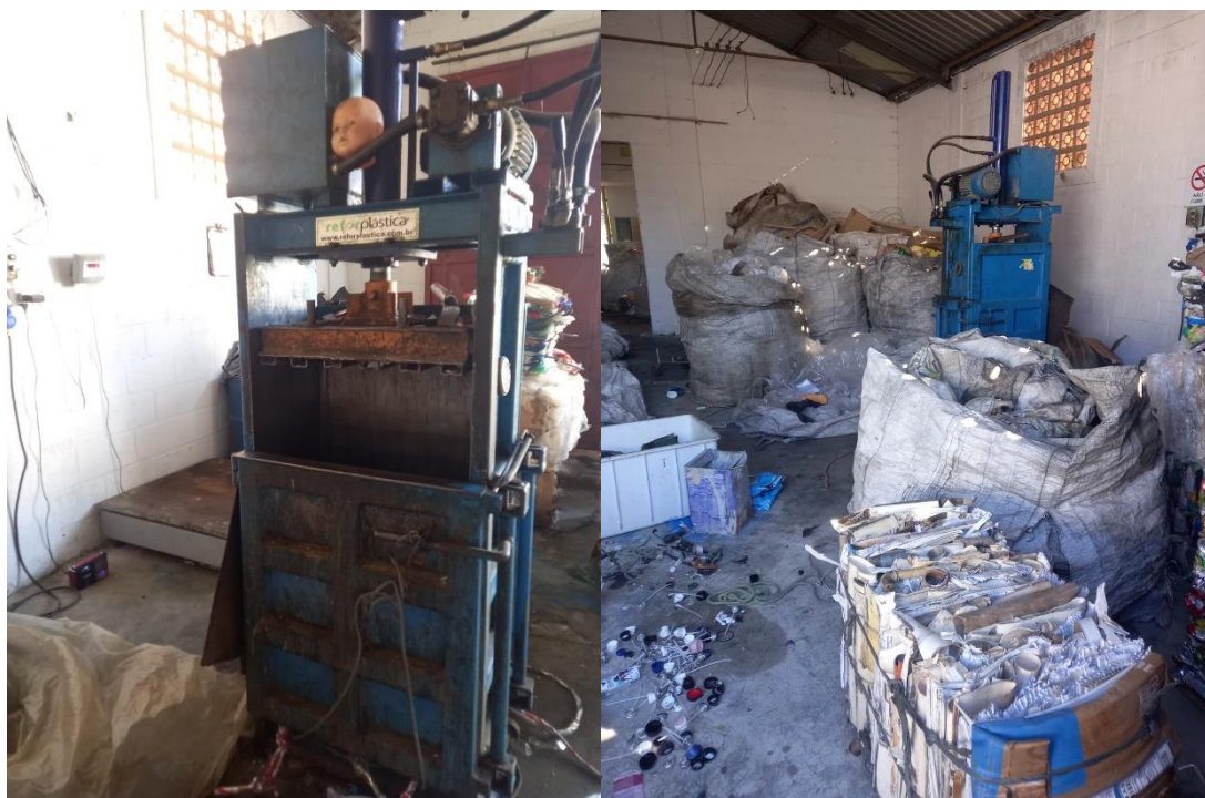
Figura: Prensa usada do processo de enfardamento
