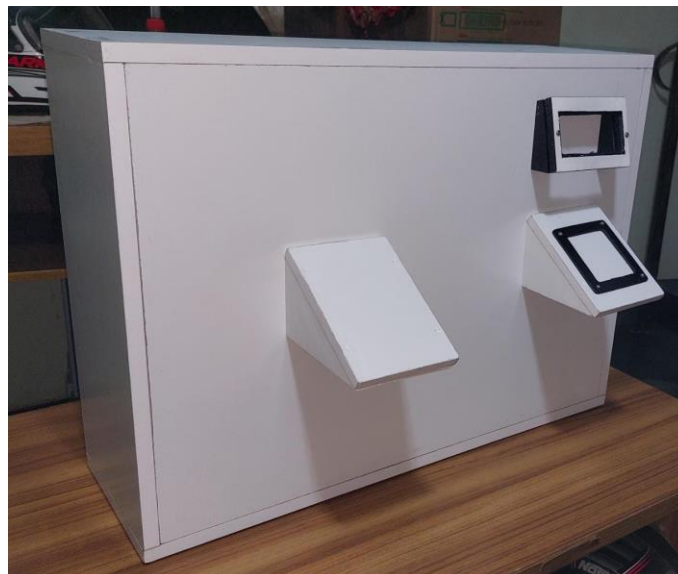
Figura 34 - Protótipo com estrutura de MDF
