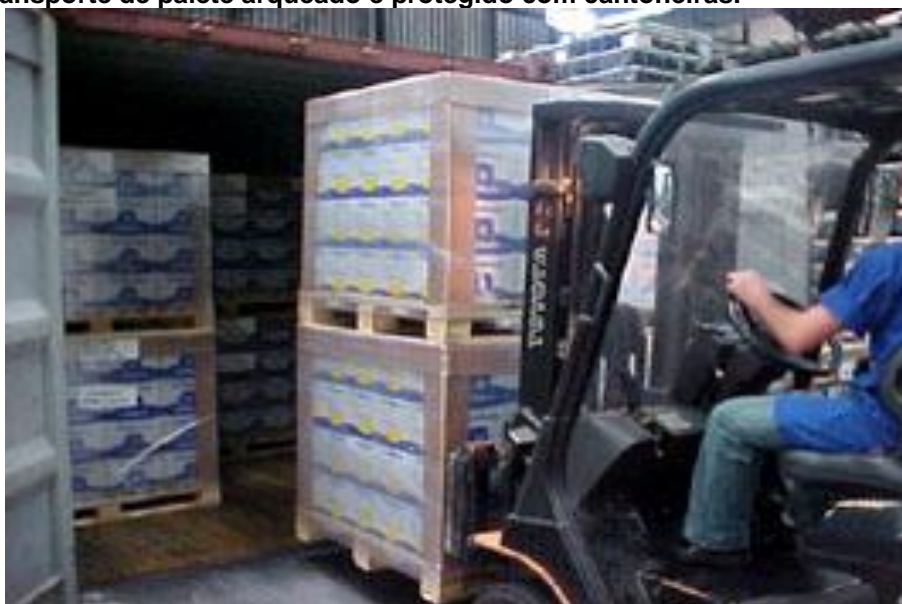
Figura 6: Transporte de paleta arqueado e protegido com cantoneiras.
