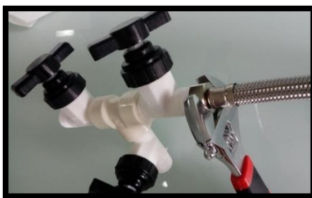
Figura 55 - Fixação das Mangueiras Flexíveis
