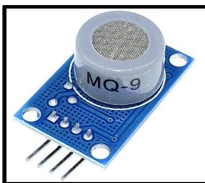
Figura 7 - Estrutura Física do Sensor MQ-9
