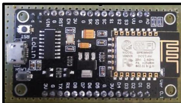
Figura 8 - Estrutura Física do NodeMCU
