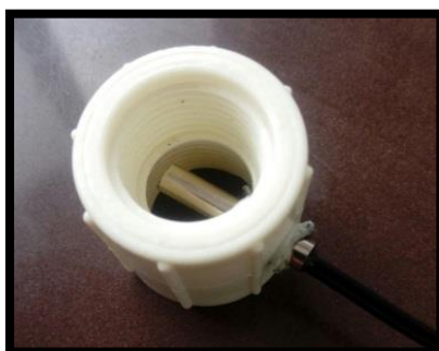
Figura 53 - Fixação da Sonda na luva
