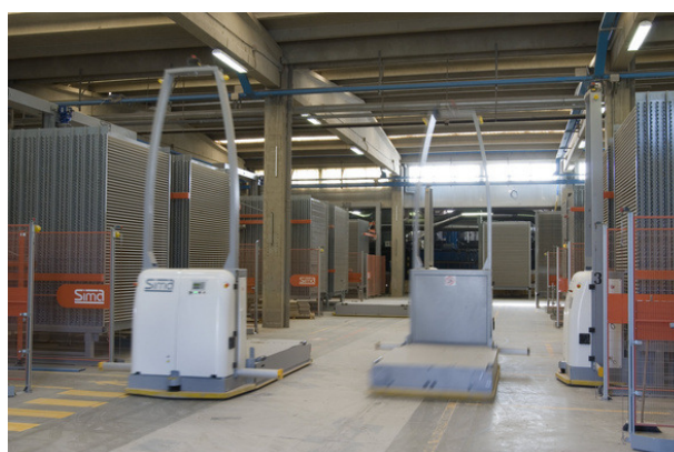
Figura 13 – Veículos Automaticamente Guiados (AGV)
