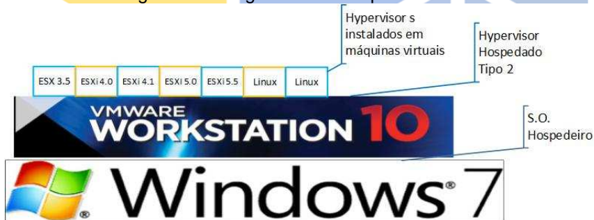
Figura 13 - Diagrama das máquinas virtuais
