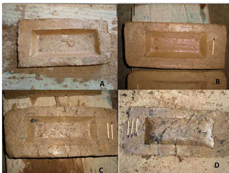
Figura 22: Aspecto geral de tijolos fabricados sem e com adição de lodo. Fonte: PIRES et.al. (2012)
