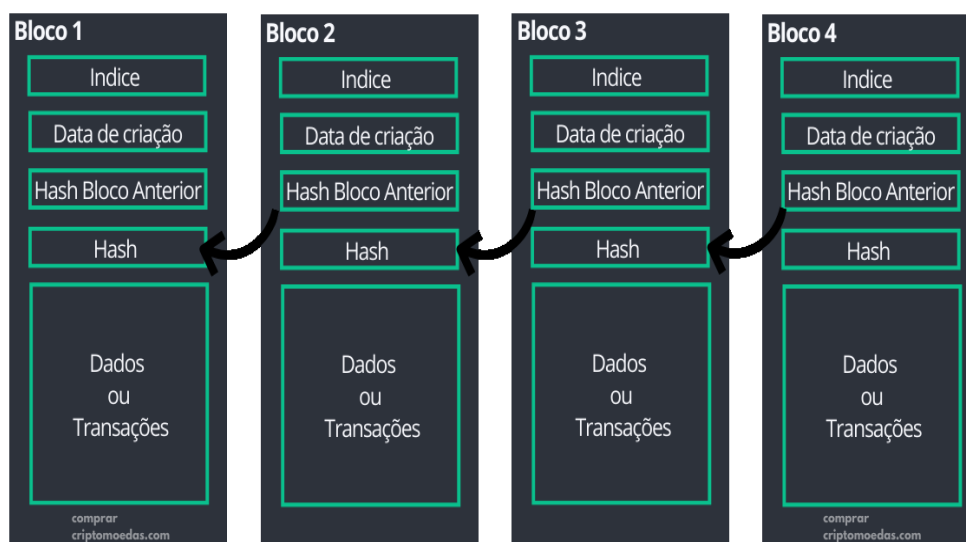
Figura 11 Blocos de hash para a criação da cadeia de dados nas transações
