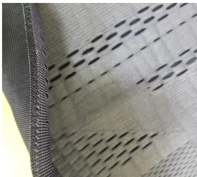
Figura 43 - Tecido raschel dupla frontura jacquard diagonal visto com foco no enchimento.
