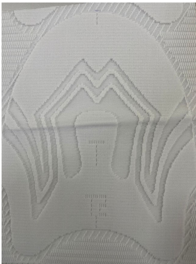
Figura 55 - Gáspea localizada com monofilamento produzida em uma máquina dupla frontura double jacquard ..
