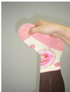
Figura 9 - Verificação das posições do "Y" e da folga na ponteira e lateral Fonte ABNT NBR 15525
