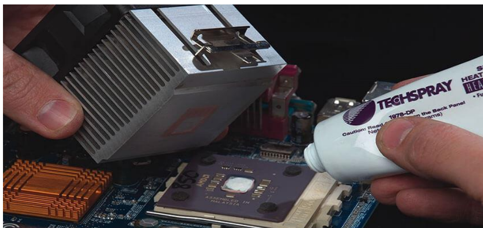
Figura 1.5 – Uso de pasta térmica na montagem de dissipador de calor.
