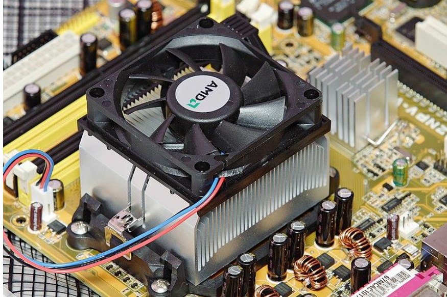
Figura 1.7 – Dissipador de calor com um microventilador, cooler , posicionado sobre ele.
