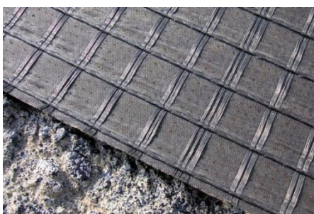
Figura 5.12: Geogrelha com camada de não-tecido. Fonte: Site Engepol (2013).
