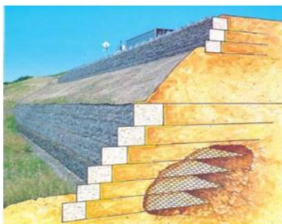
Figura 5.14: Reforço de solo em talude.
