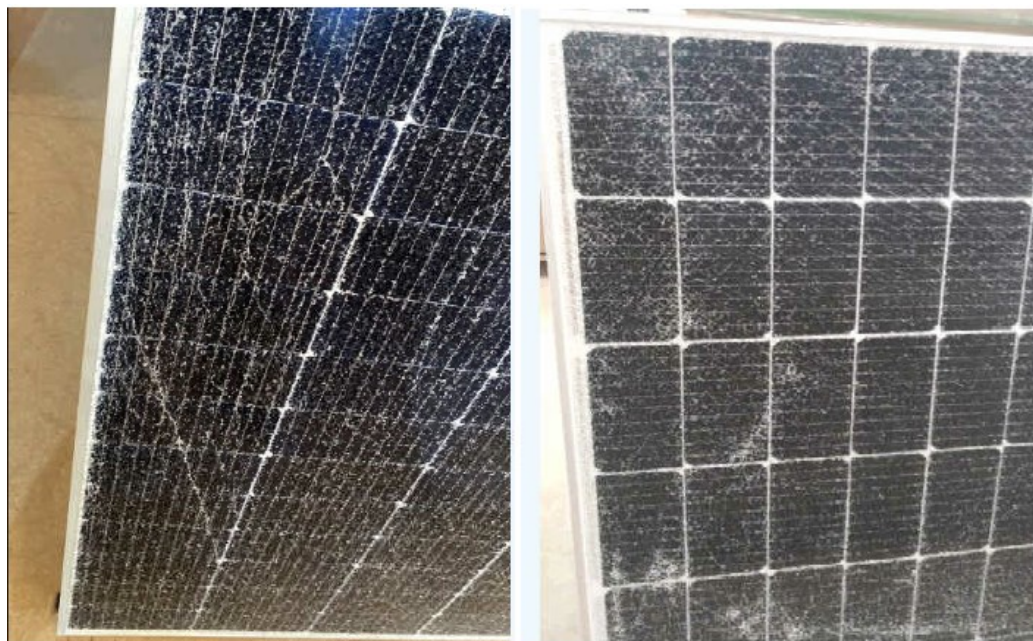
Imagem 7 - Placa quebrada no Cliente
