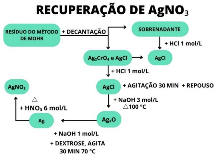
Figura 1: fluxograma do método de recuperação do nitrato de prata. Fonte: Autores.
