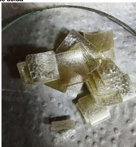
Figura 2: amostra de PET após ser submetida a sua hidrólise ácida
