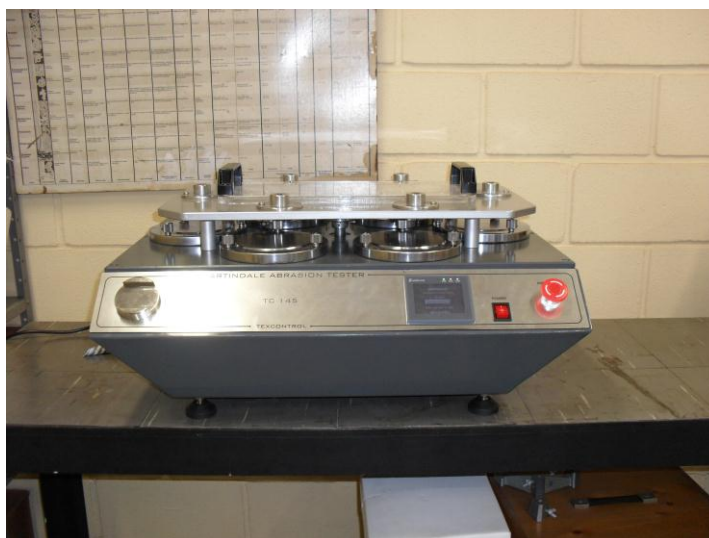
Figura 23 - Abrasímetro Martindale Mod. TC 145
