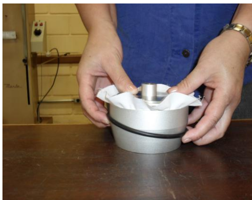
Figura 33 – Colocação do O'ring (anel de borracha)
