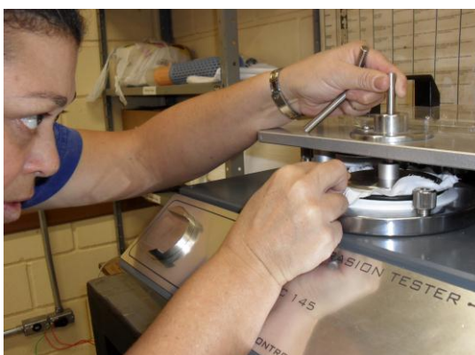
Figura 38 – Fixação dos pinos
