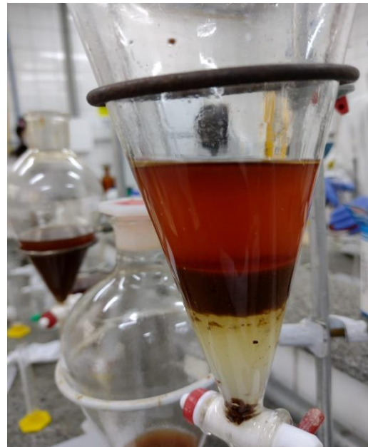
Figura 12 - Sistema de extração de lipídeos contidos no chocolate vegano com 2,5 gramas de amostra
