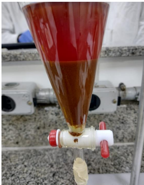
Figura 11 - Sistema de extração de lipídeos contidos no chocolate vegano com 5 gramas de amostra
