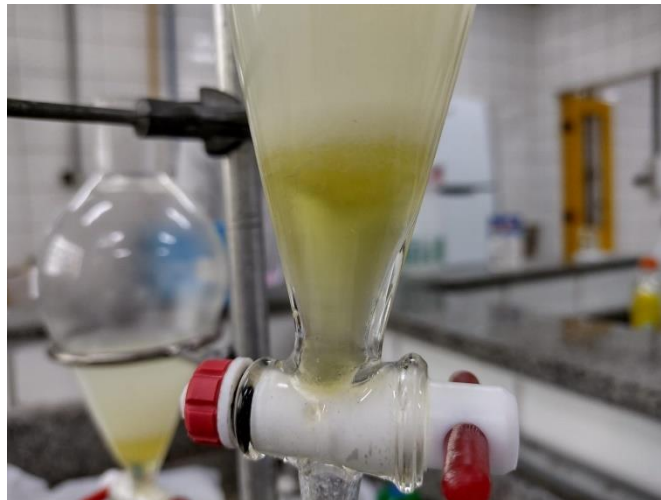
Figura 10 - Sistema de extração dos lipídeos presentes em amostra de chocolate branco utilizando solução de sulfato de sódio 1,5%
