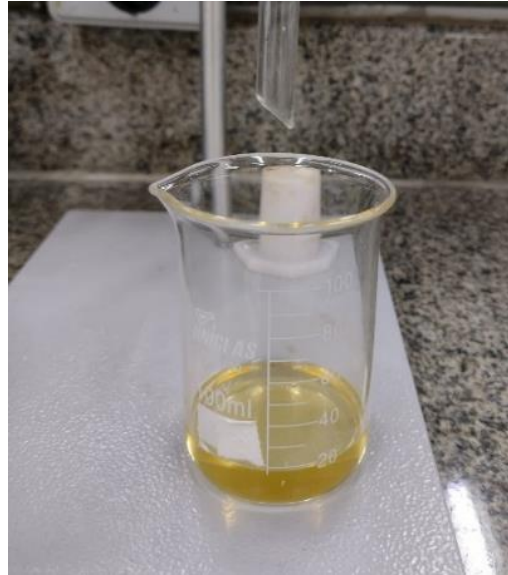
Figura 16 - Filtrado proveniente da extração de lipídeos do chocolate vegano (clorofórmio e gordura)
