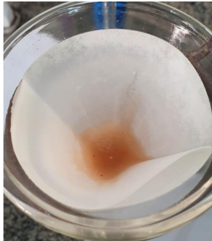
Figura 17 - Umidade e impurezas retidas na filtragem mediante adição de sulfato no chocolate vegano
