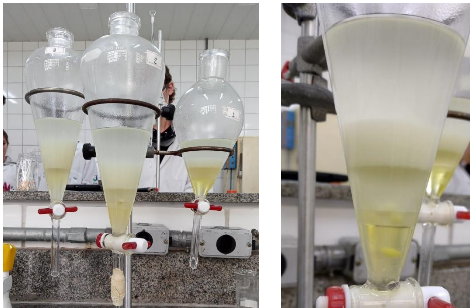
Figuras 14 e 15 (nessa ordem) - Sistema de extração de lipídeos em 5g de chocolate branco
