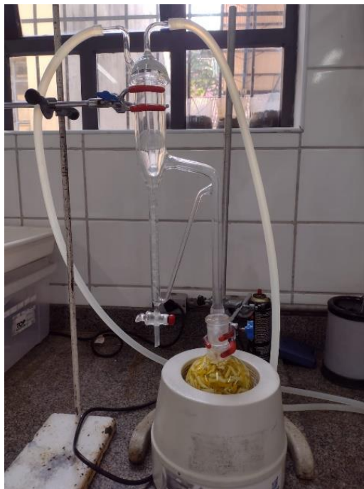
Figura 4 – Sistema de extração dos óleos essenciais (aparelho de Clevenger)
