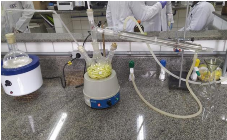
Figura 2 – Sistema de extração dos óleos essenciais por arraste a vapor
