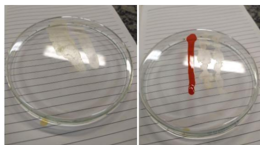
Figura 15 – Aspecto dos testes de fluxo do esmalte desenvolvido (à esquerda) e do esmalte comercial (à direita).
