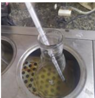
Figura 2 – Mistura de óleo no aquecimento em banho-maria
