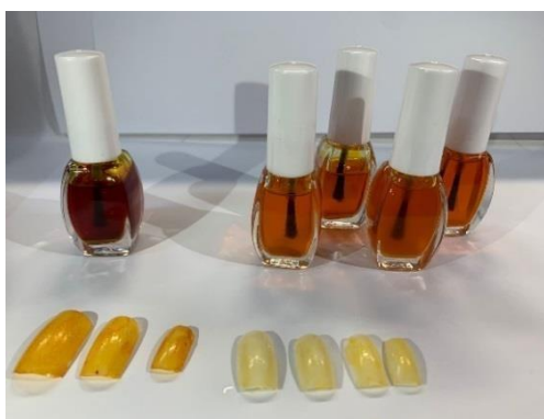
Figura 14 – Aspecto dos testes de aplicação do esmalte industrial (à esquerda), com óleo de banana (central) e o lote 5 de esmalte sem óleo de banana (à direita).
