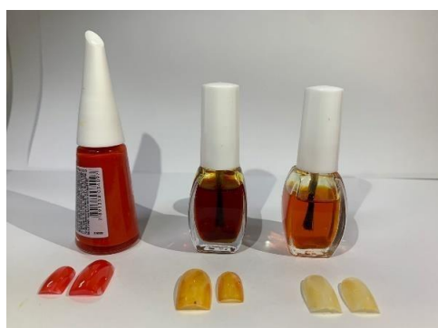
Figura 14 – Aspecto dos testes de aplicação do esmalte industrial (à esquerda), com óleo de banana (central) e o lote 5 de esmalte sem óleo de banana (à direita).
