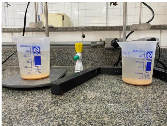
Figura 18: Béqueres com água 500 NTU e 1000 NTU após decantação. Acervo Pessoal.
