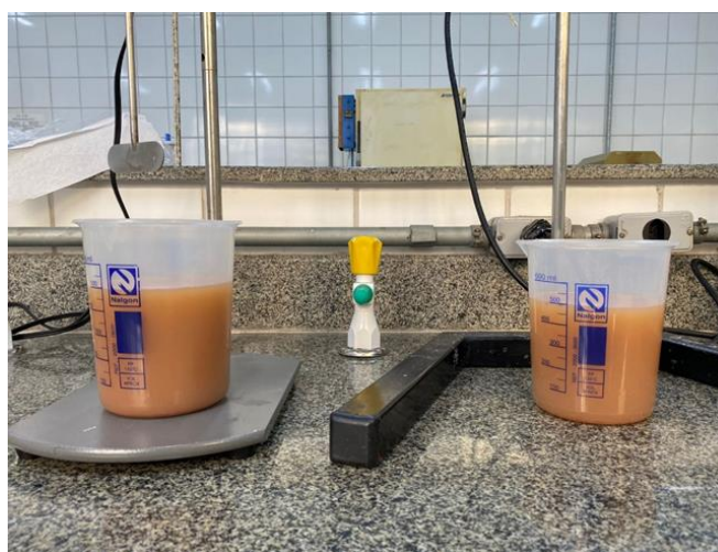
Figura 17: Béqueres com água 1000 NTU e 500 NTU em agitação. Acervo Pessoal.
