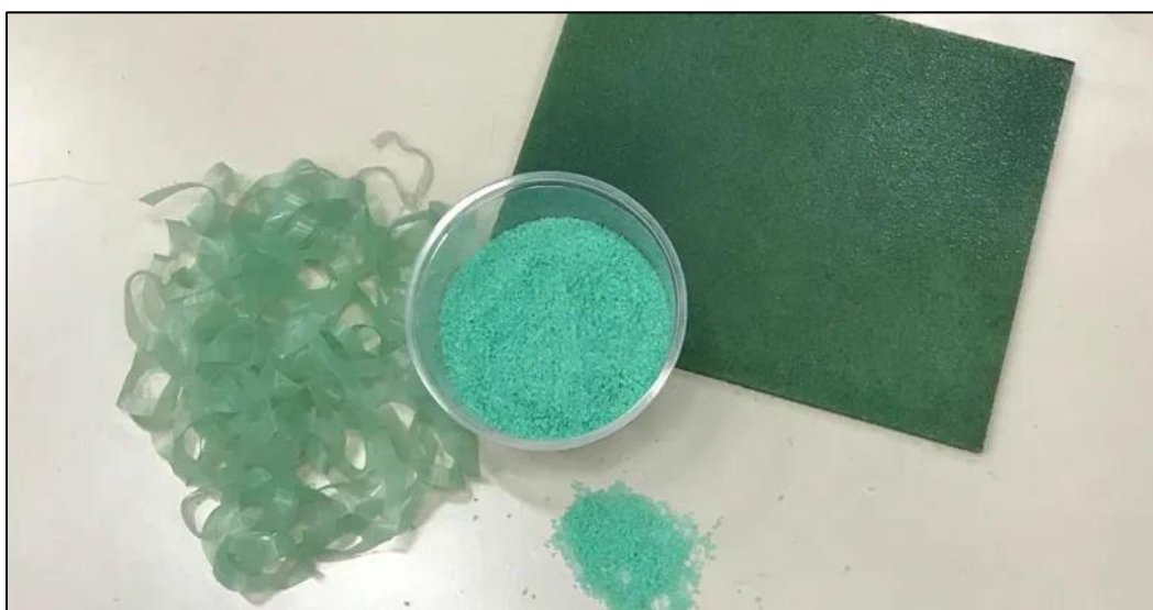
Figura 3 - Resíduo de calçados transformado em material resistente, dielétrico e antichamas
