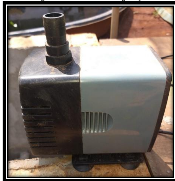
Figura 14: Bomba de Oxigenação
