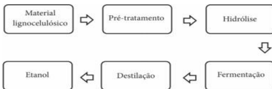
Figura 1 - Processo simplificado da produção de etanol de segunda geração.
