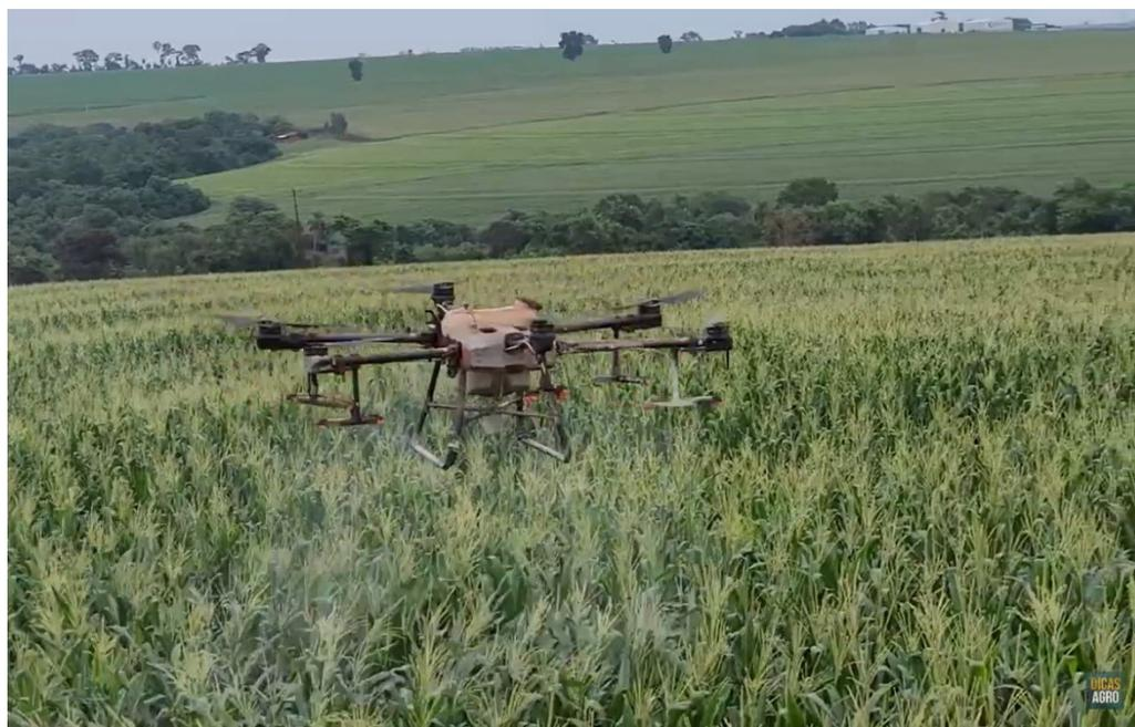
**Fig. 4** - Drone pulverizando cultura de milho.
