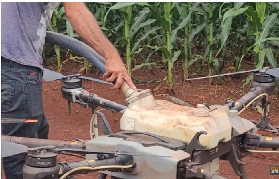
**Fig. 1** - Abastecimento de calda líquida para aplicação via pulverização aérea.
