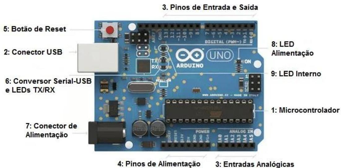
Figura 4: Blocos do arduino Uno (MOTA, 2021)
