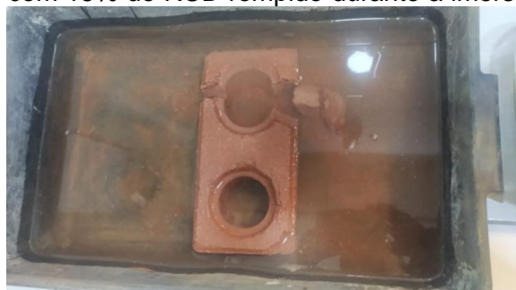
Figura 32 – Bloco com 15% de RCD rompido durante a imersão (após 7 horas).
