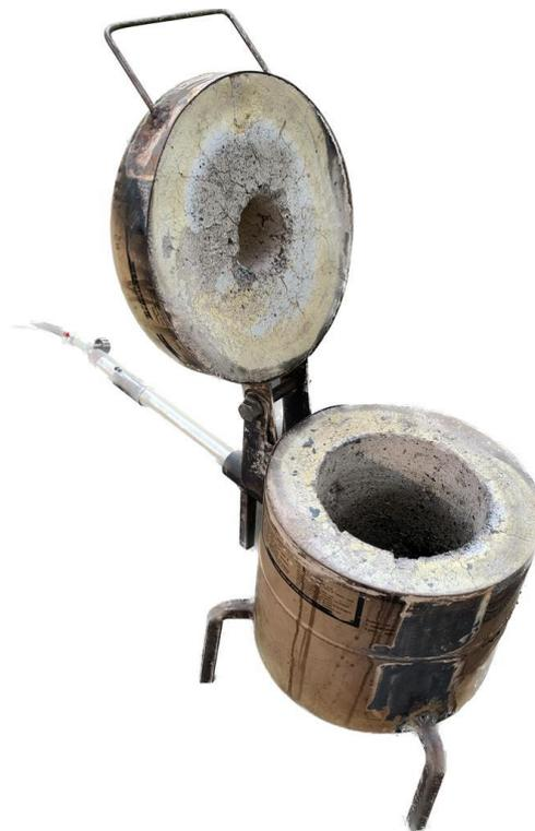
Figura 20: estrutura do forno de fundição de pequeno porte com o revestimento refratário
