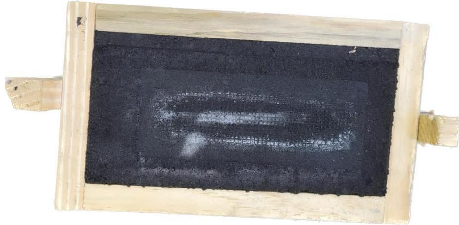
Figura: 23: molde fechado com o líquido já vazado
