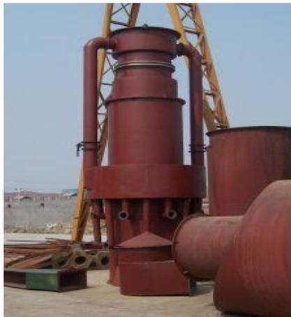
Figura 14: forno de cúpula
