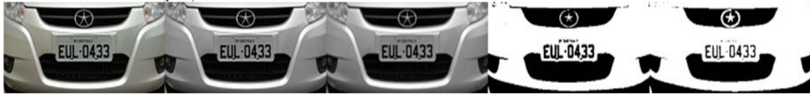
Figura 4 – Comparação da imagem original e aplicação dos filtros de processamento digital (Em ordem: Imagem Original, Escala de Cinza, Gaussian Blur, Threshold, Dilatação)
