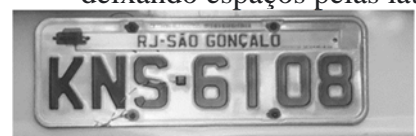
Figura 8 – Exemplo de placa recortada erroneamente deixando espaços pelas laterais da placa
