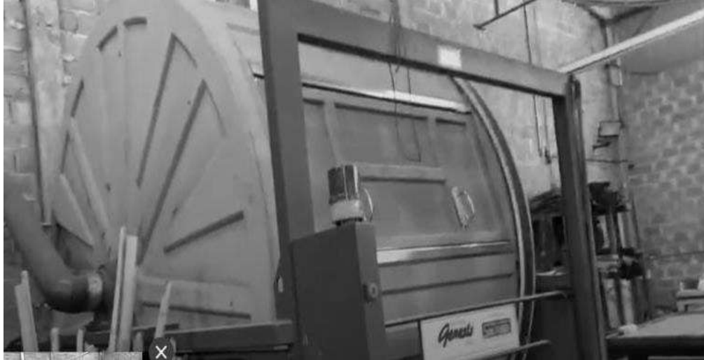
Figura 7 - Imagem de fulão utilizado no processo de amaciamento do couro.
