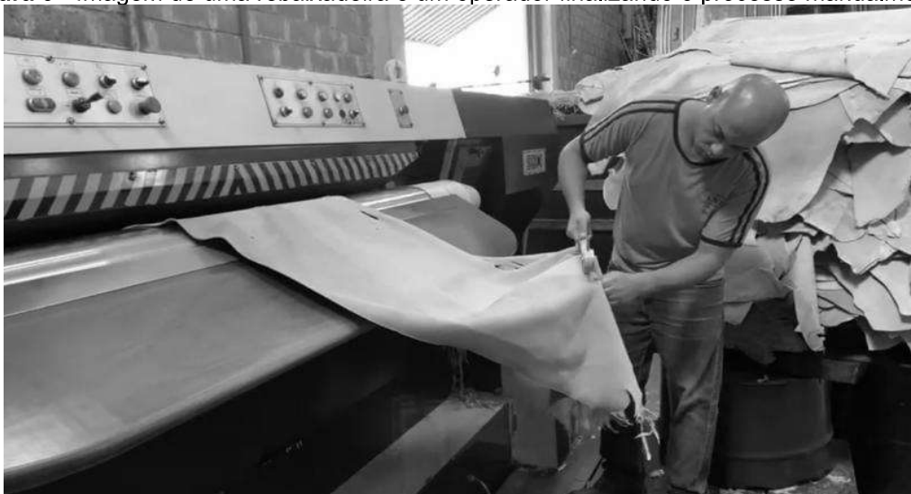
Figura 3 - Imagem de uma rebaixadeira e um operador finalizando o processo manualmente.
